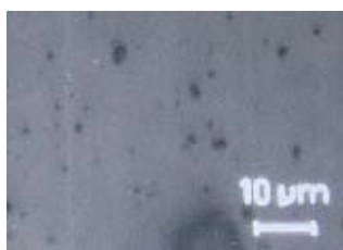
図3 Cu 2 Se粉末を粉碎した状態
