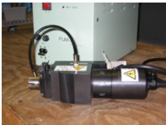
写真1 超音波振動切削装置
