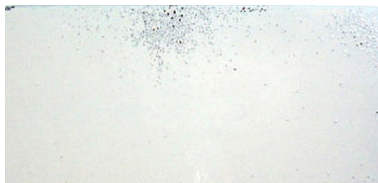
図 4 上釉を焼き付けたFC200組成試験片
