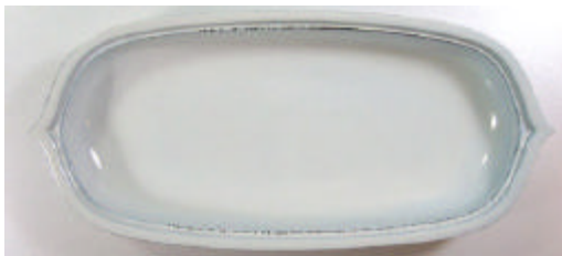
図11 実製品の焼成状態(上釉)
