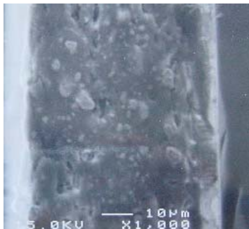
ガラス基板 | \text{Cu}_2\text{Se} / \text{In}_2\text{Se}_3 | \text{In}_2\text{Se}_3 / \text{Cu}_2\text{Se} | ガラス基板
