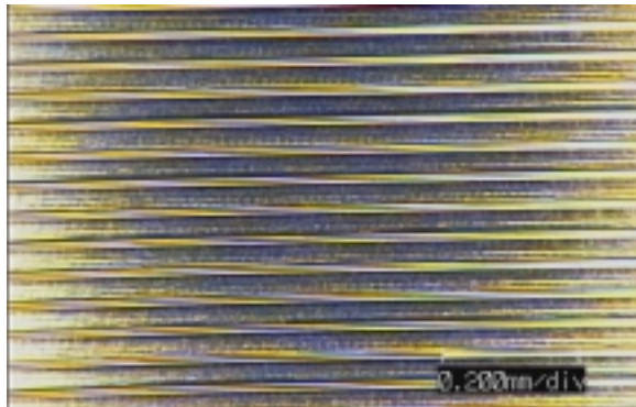
v = 20\text{m/min} f = 0.1\text{mm/rev} a = 0.025\text{mm/回} , 被削材: SKH51 (HRC63), 超硬工具, 振動切削 写真2 振動切削時の加工面写真
