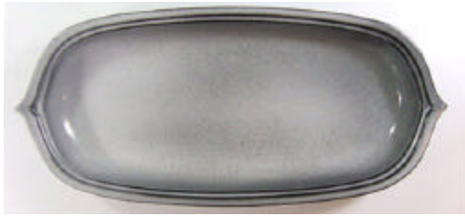
図10 実製品の焼成状態(下釉)
