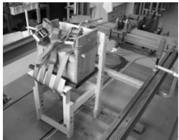
写真5 いすの繰り返し耐衝撃性試験
