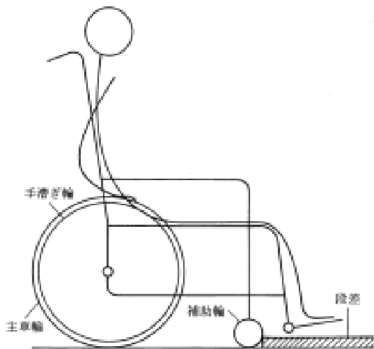
図1 段差に直面した車椅子の状態
