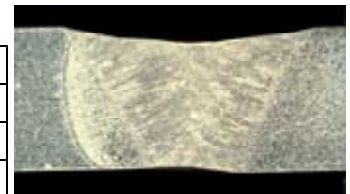
図14 TIG溶接条件と断面マクロ組織
