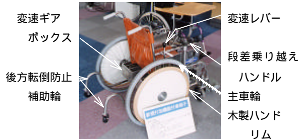
図3 試作した新機能付加車椅子の外観
