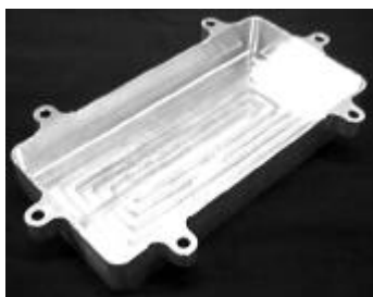
図4 インパルスハンマーによる減衰比測定用供試体
