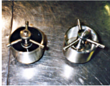
図1 タフネス・テナシティ試験持具
