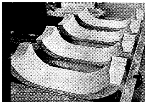
写真8 NCルータ加工終了時の状況
