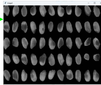
図2 穀粒判別機の画像は、酒米の向きが不揃いのため、平均画像計算のために向き合わせが必要
