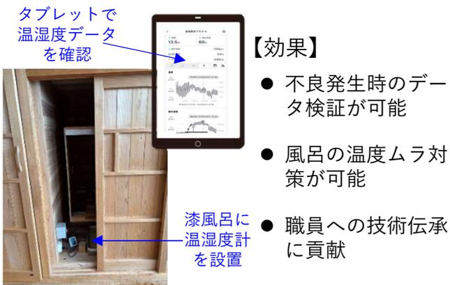
図2 漆器乾燥における温湿度管理のデジタル化
