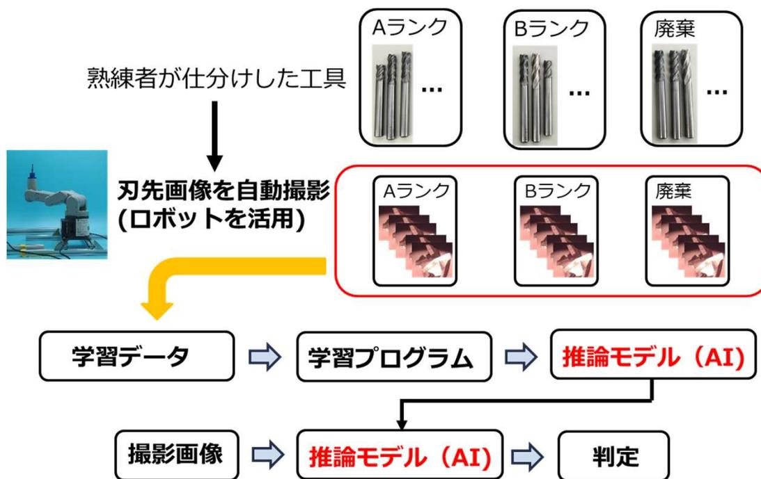
図1 診断システムの概要
