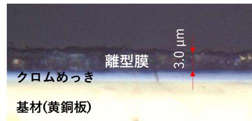
図2 離型膜断面のマイクログラフ写真
