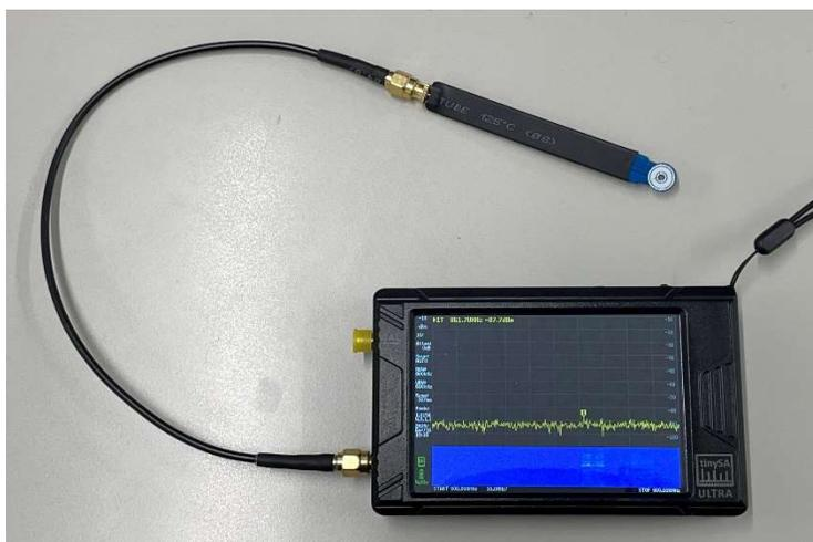
図1 TinySA ULTRAと近磁界プローブ
