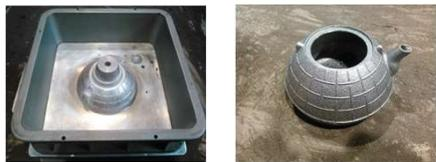
造型枠にセットした金型      砂落とし及び加工後の試作品
