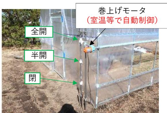
図3 ビニルハウス開閉部の機構
