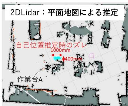
2DLidar：平面地図による推定
