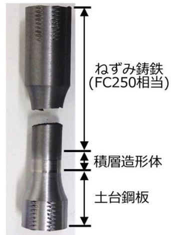
図4 破断後の引張試験片
