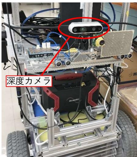
図4 深度カメラを搭載した搬送ロボット
