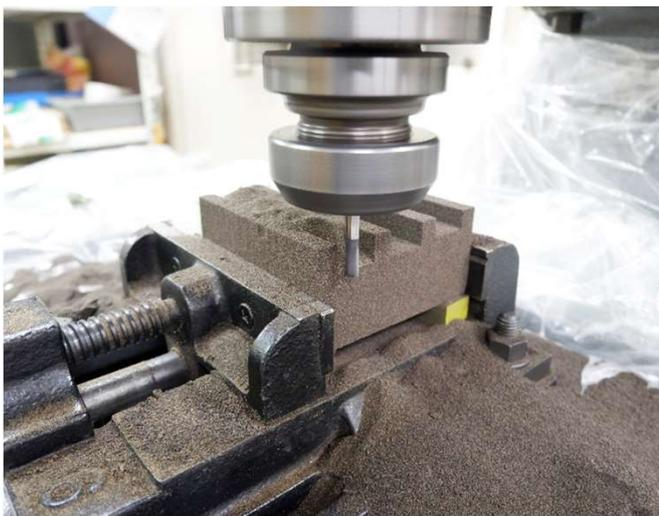
図1 砂型の切削加工実験
