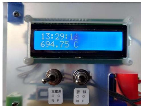
図2 システム検証(電気炉内の温度計測)
