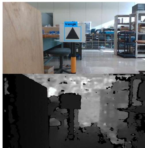
図5 深度カメラによるRGB画像と距離画像
