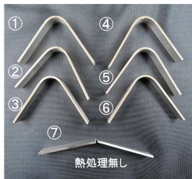
レーザ熱処理条件と曲げ試験結果
