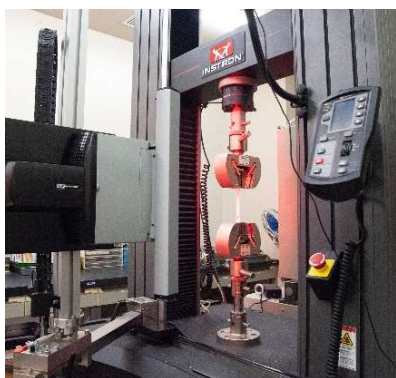
Instron 5982型による試験の様子
