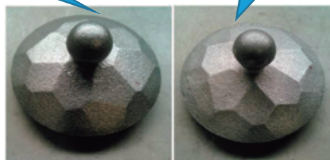
急須蓋の試作品 (左：樹脂3Dプリンタ、右：切削加工)
