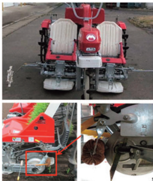
図1 汎用苗田植機と移植爪取り付け例
