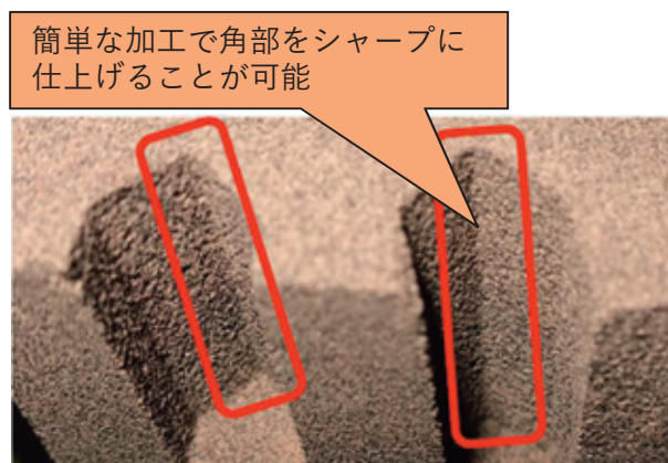
図6 角R仕上げ工具で加工した角部
