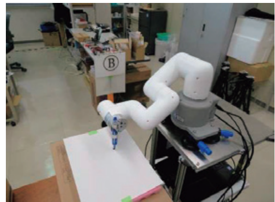
(a) 実験コース (b) ペン先で目標位置に打点 図1 アームロボットを搭載した自律移動ロボットの外観写真
