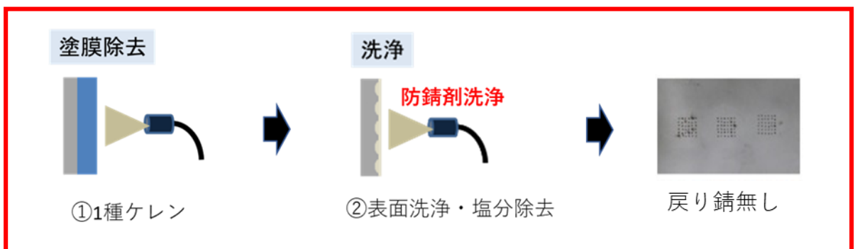
図2 開発工法及び表面状態
