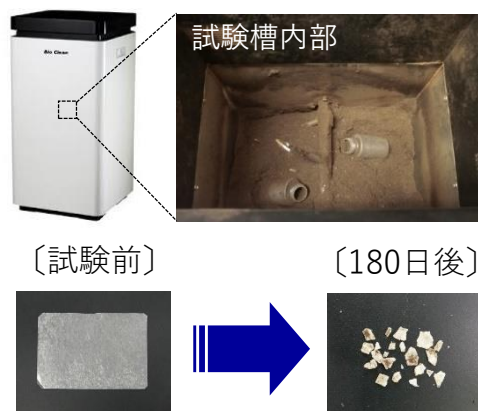
コンポスト化装置(上)を用いた生分解性試験中の試験片外観(下)
