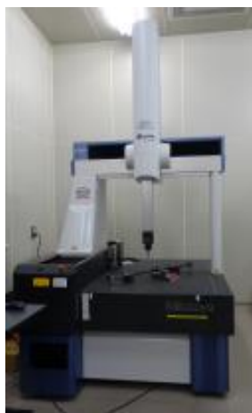
図3 ゲージの標準値の値付けに使用した三次元測定機の全景（左）とゲージ測定の様子（右）
