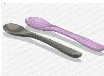
3Dスキャンデータ（右）と 再モデリングデータ（左）
