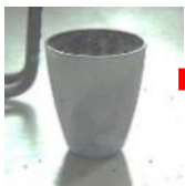
専用カップで溶湯80gを採取し真空チャンバへ
