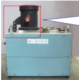
専用カップで溶湯80gを採取し真空チャンバへ
