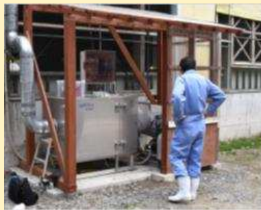
図1 開発中の光触媒空気清浄機 (左：家庭向け 右：畜産分野向け)
