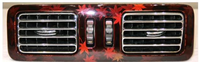
図3 漆塗装した車載部品モデルの試作
