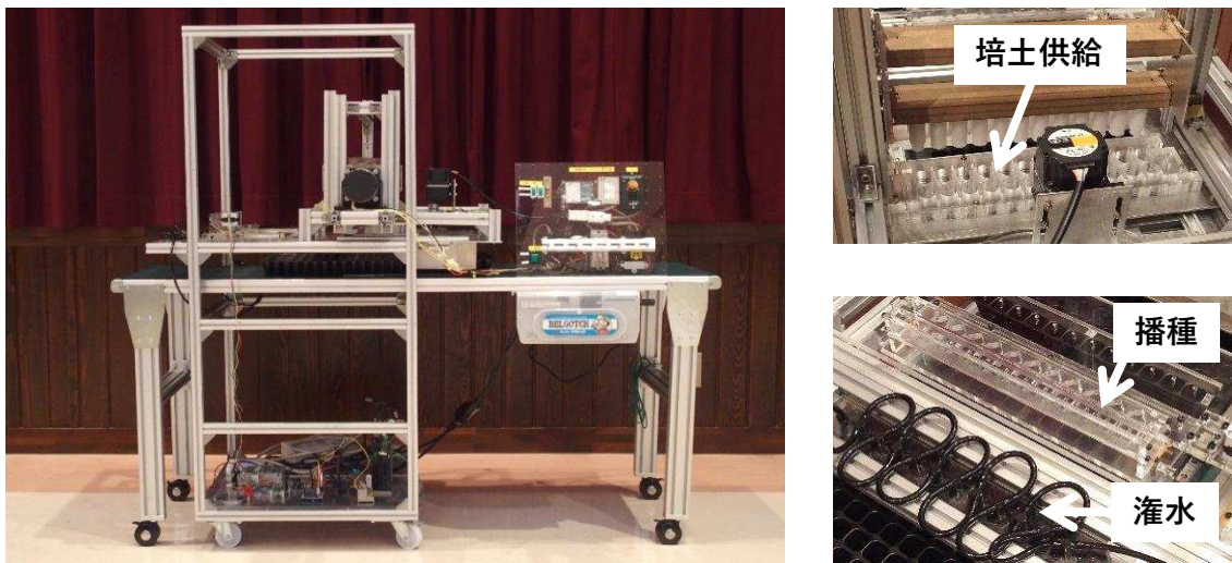
図1 自動播種ロボット試作機
