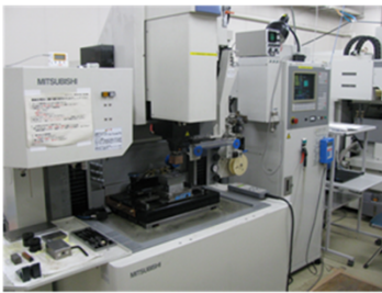
図1 形彫り放電加工機
