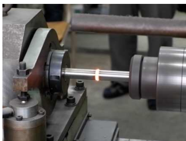
図1 摩擦圧接の様子
