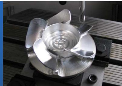
図4 5軸M/Cで加工したファン翼
