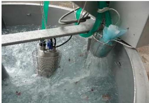
写真2 異物回収装置および洗淨の様子
