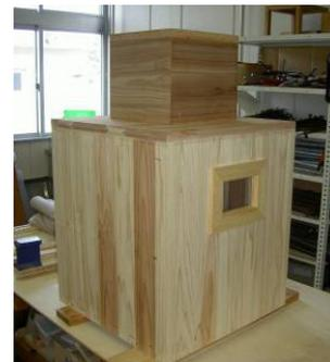
図4 乾式木製発酵槽
