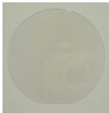
図2 MOCVDでサファイヤ基板上に作製したZnO薄膜
