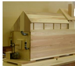
図2 横型木製発酵槽
