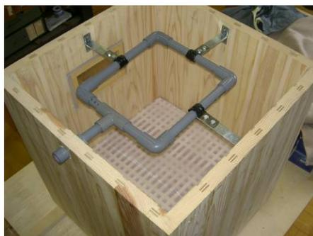
図3 乾式木製発酵槽内部
