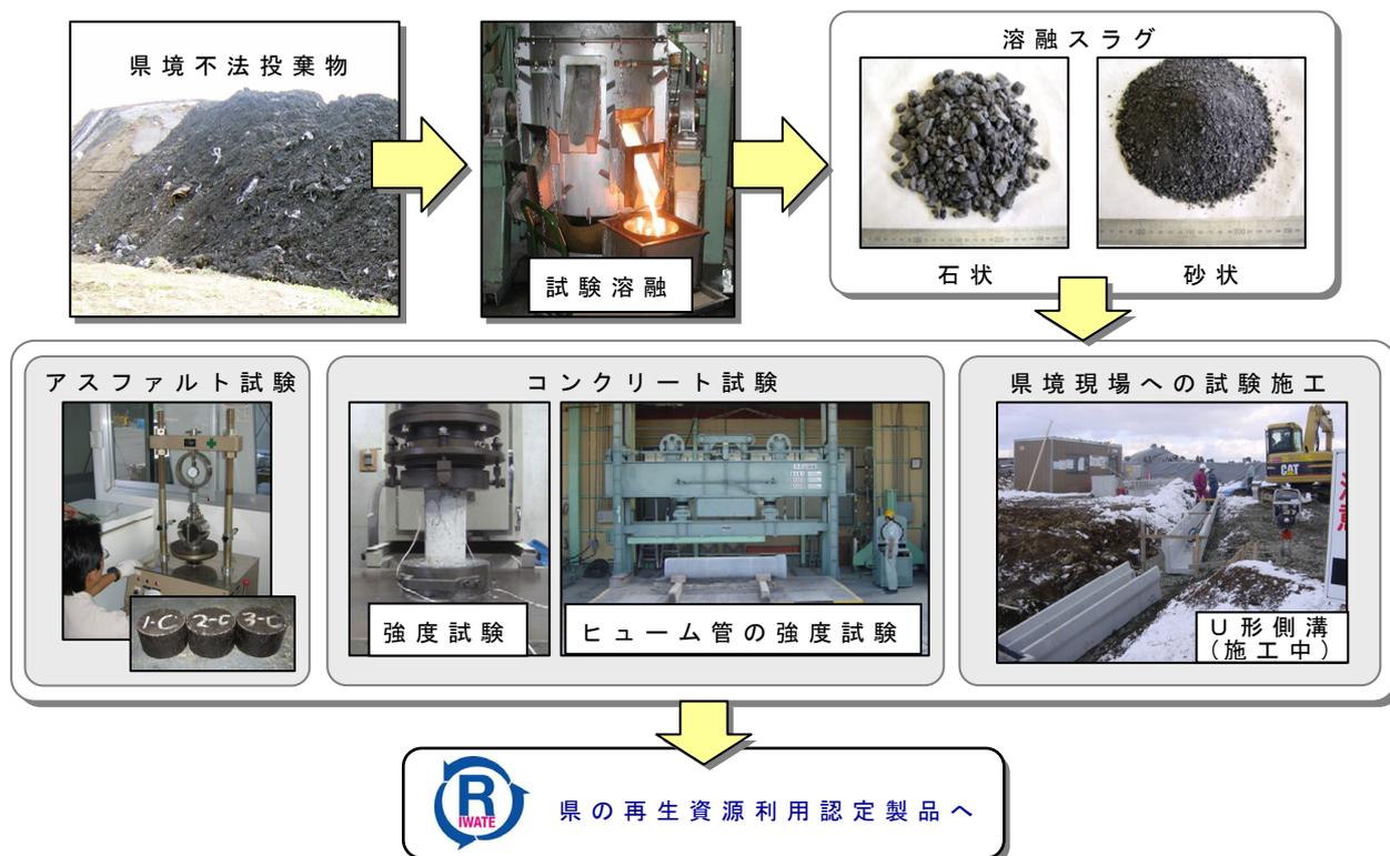
図 1 不法投棄物を溶融スラグに変換して再資源化
