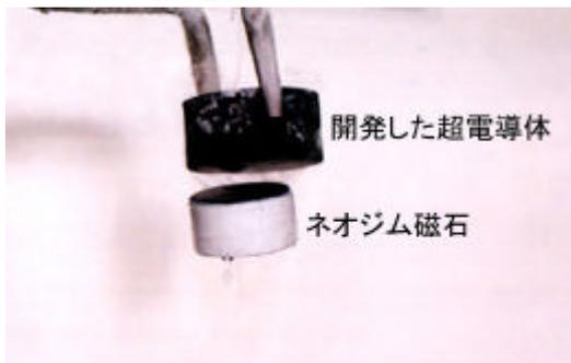
液体酸素で冷却した超電導体でネオジウム磁石を空中に吊り下げている
