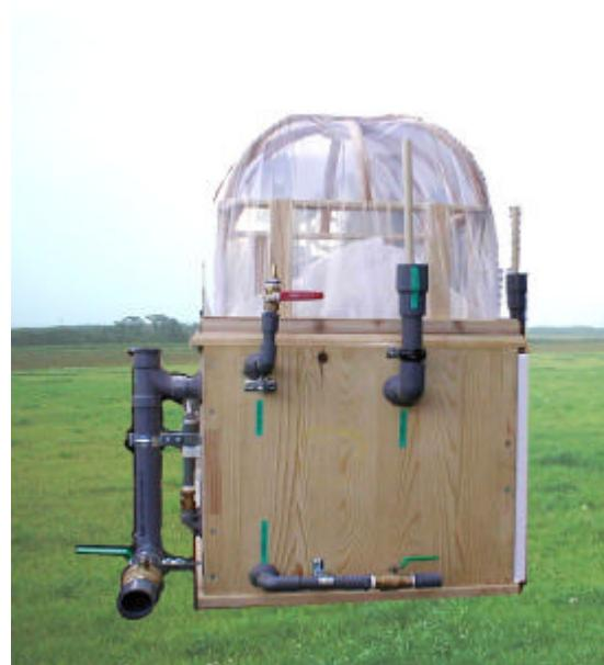
図1 試作木製醸酵槽(メタンストックシステム)
