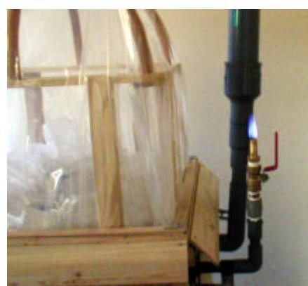
図2 メタンガス発生確認状況
