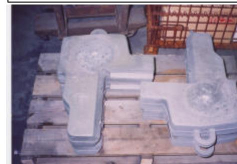
図3 試作した破碎歯
