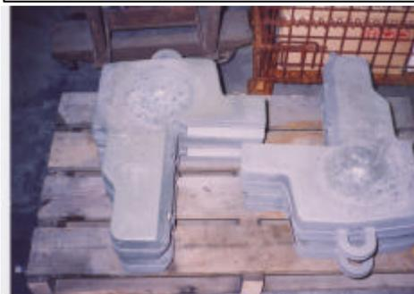
図3 試作した破碎歯
