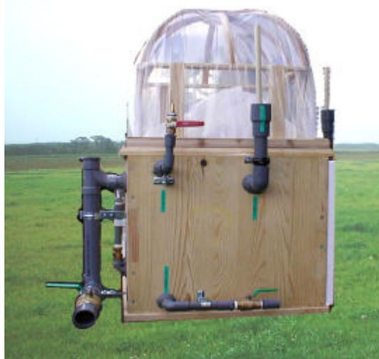
図 1 試作木製醗酵槽 (メタンストックシステム)
