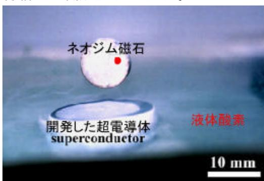
液体酸素中で冷却した超電導体を使ってネオジウム磁石を浮上させている
