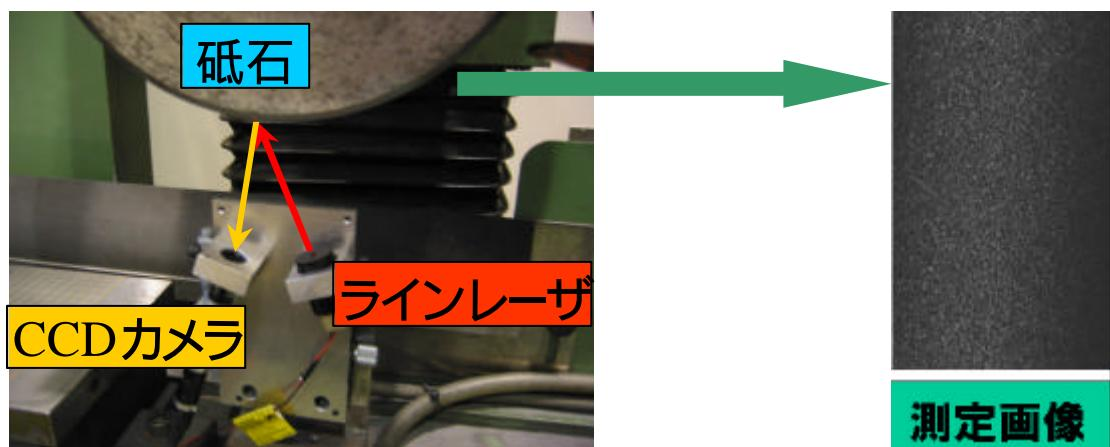
図2 レーザ光を用いた砥石表面の摩耗測定システム
