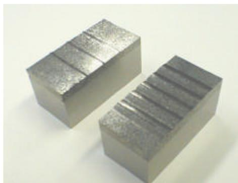
図1 試作した打ち抜き金型
