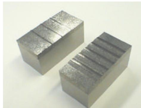
図1 試作した打ち抜き金型
