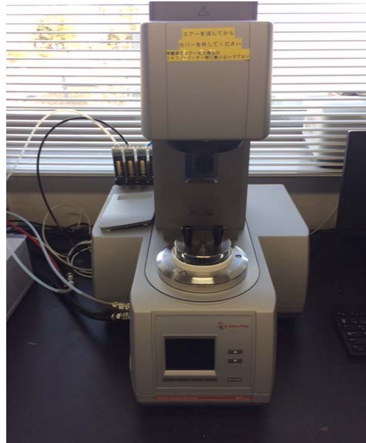
図2 レオメーターの装置外観
