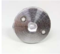
【図 2-1 カントバック試験片 (左：円柱部、右：分析面)】
