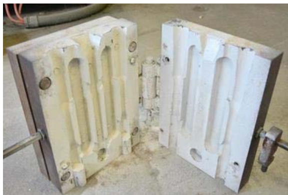
図2 金型試験片採取用供試材製造鑄型 (JIS H 5202)
