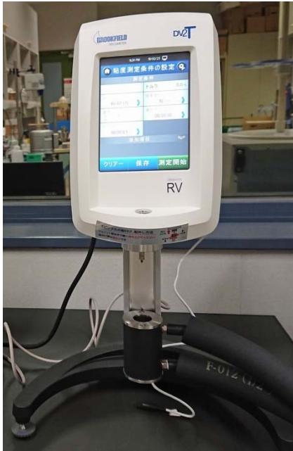
図1 B型粘度計の装置外観
