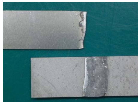
図10 引張せん断試験における破断
