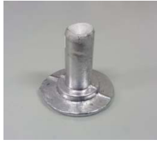
【図 2-1 カントバック試験片 (左：円柱部、右：分析面)】
