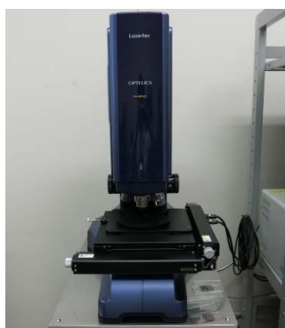
図 3 共焦点レーザー顕微鏡の装置外観
