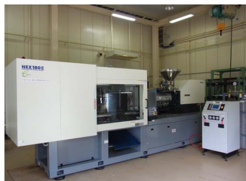
図 2 超臨界発泡射出成形機
