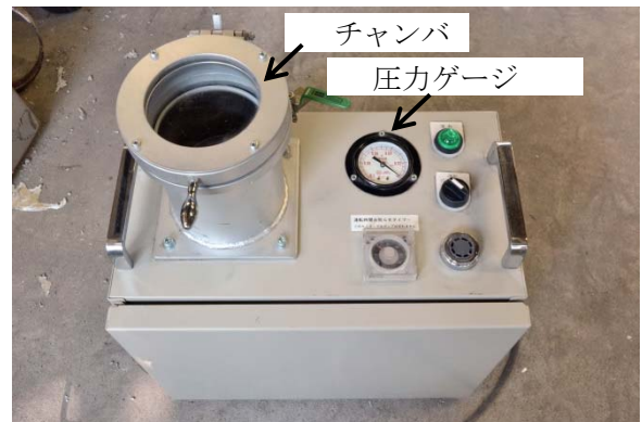
図3 減圧凝固試験機 (ピンテスター)
