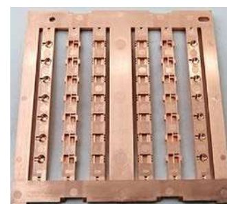
図2 ファインバブル+分子接合処理 (全面めっきに成功)
