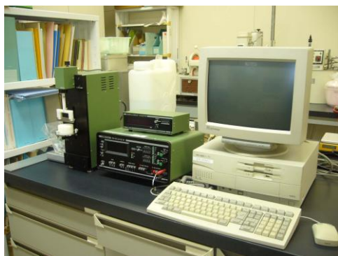
岩手県工業技術センター所有 物性試験システム (クリープメータ)
