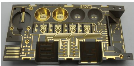
図4 立体成形品への配線形成 (左) とめっき断面のSEM写真 (右)
