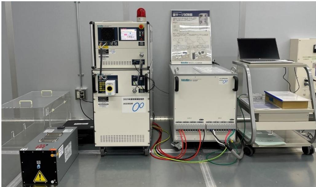
雷サージ試験器は、落雷電流による大地の電位変動や屋外の電力線、信号線に誘導された「高エネルギーの誘導雷ノイズ」を模擬的に発生し、電子機器の耐性を評価する試験器です。
