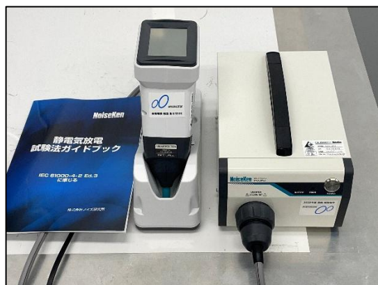
静電気放電試験器 (更新)
