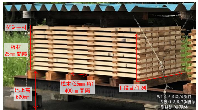
写真1 クリの栈積みの状況
