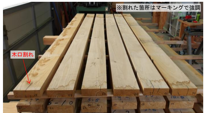
写真2 クリの材面の状況(117日経過後、栈積み6段目)
