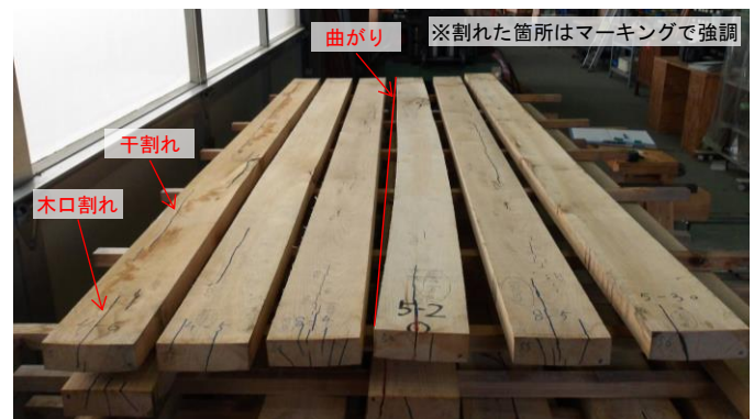
写真2 ナラの材面の状況(115日経過後, 栈積み6段目)
