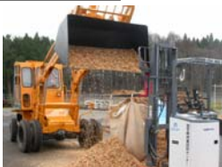
写真-3 小型リフト使用詰込作業
