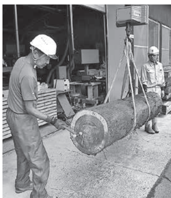
写真7 丸太の強度測定の様子
