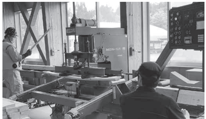
写真2 ラミナの曲げヤング係数の測定
