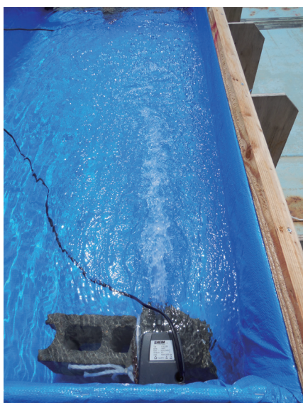
図5 水槽内に設置した水中ポンプ Fig. 5 A submersible pump placed in the tank
