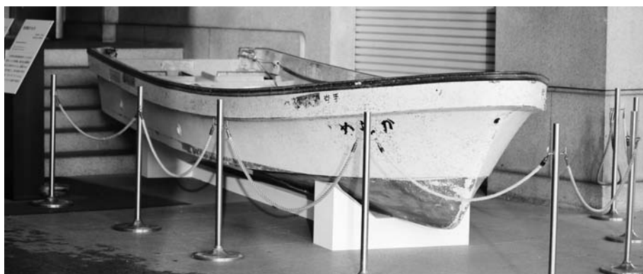
写真3 全長約533cm、幅176cm、高さ67cm、重量0.6t FRP製
