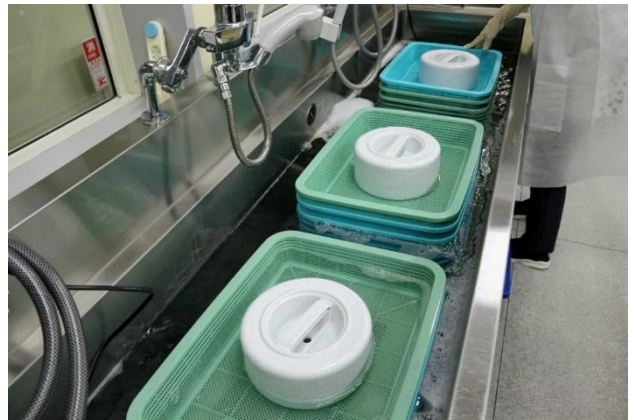
図 6. (2)-2 安定化処理（中性洗剤による洗浄）
