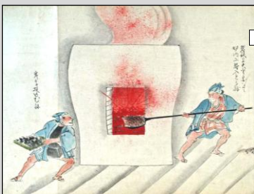
⑤ 鉄鉱石と炭を1対2の割合で2階の作業場から高炉に入れる
