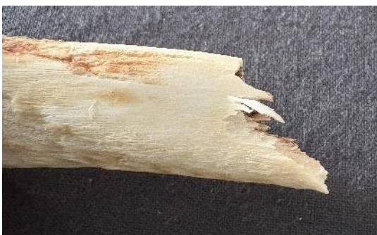
水分除去状態で折割り資料の断面 (段差が生じ、外皮はササクレ状)
