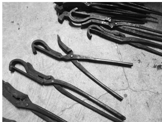
写真1 熊谷鉄工所においてアワビカギ整形に使用されている型の例
