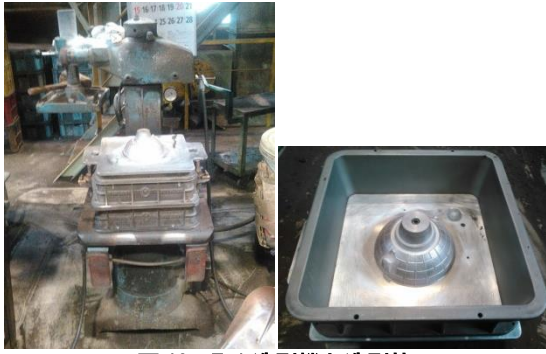
図18 F-1 造型機と造型枠
