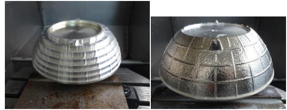
図12 原型上側の加工（左：中荒、右：完了後）
