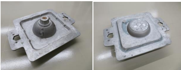
図10 マッチプレート金型の例（左：上側、右：下側）
