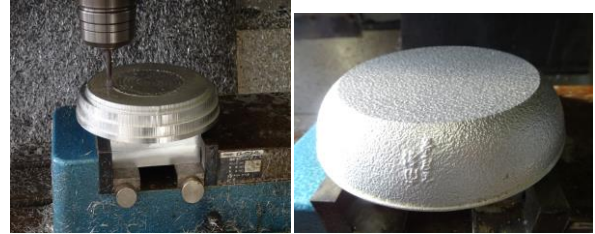
図13 原型下側の加工（左：荒、右：完了後）
