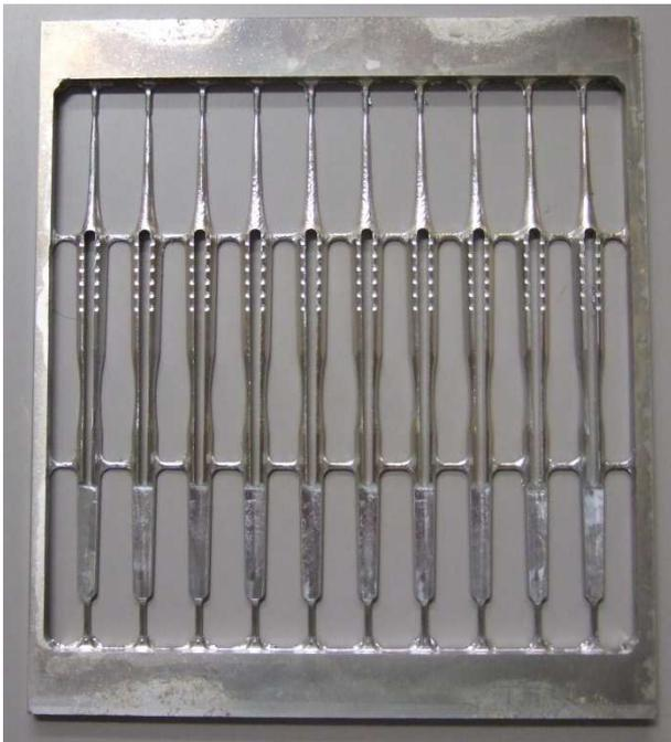
図10 加工サンプル（隙間7mm、10個取り）
