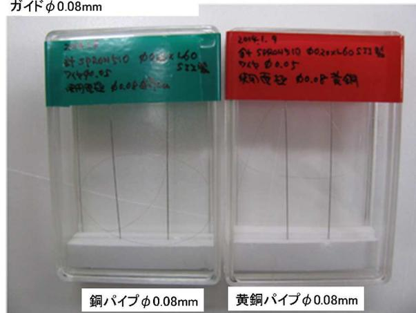
図8 棒材へのワイヤ通しサンプル
