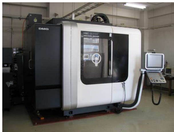
図1 導入した5軸マシニングセンタの外観
