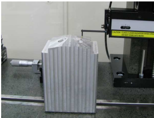
図4 加工面粗さ測定
