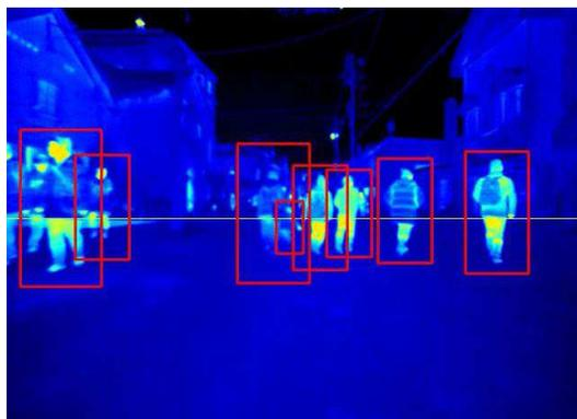
図15 夜間の遠赤外線カメラ検知結果
