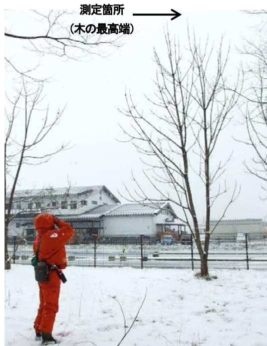
図3 パーテックスによる樹高測定
