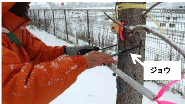
図4 輪尺による幹の胸高直径測定
