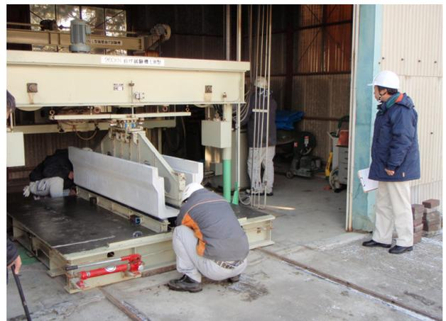
図10 U形側溝の製品曲げ強度試験
