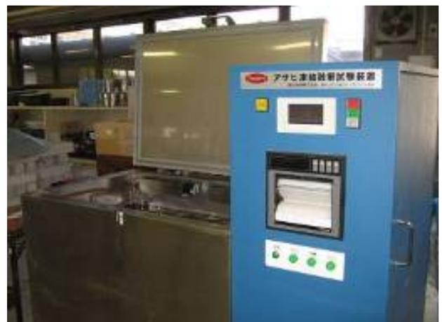
図8 凍結融解試験装置
