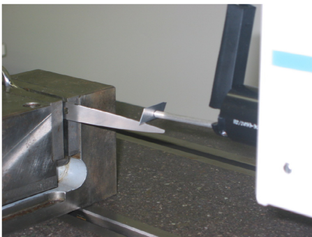
図2 刃先端粗さ測定
