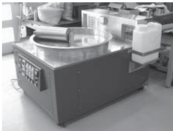
図2 試作した速乾性漆液加工装置
