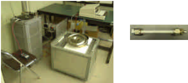
図1 バッチ式超臨水界抽出反応槽及び反応容器
