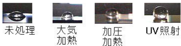
図5 各種重合処理したFRTD被膜の接触角
