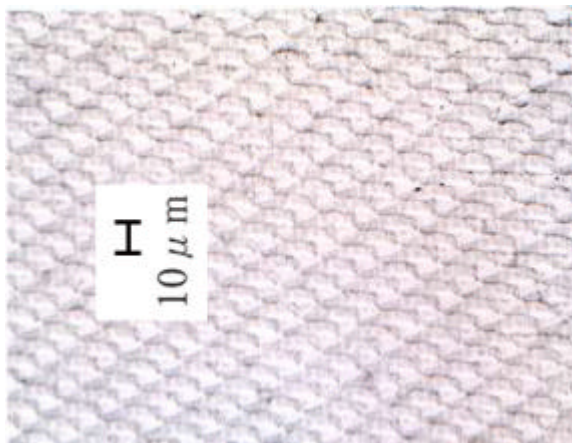
a) s=1500\text{rpm}, f=7.5\text{mm}/\text{min} (=5 \mu\text{m}/\text{rev})
