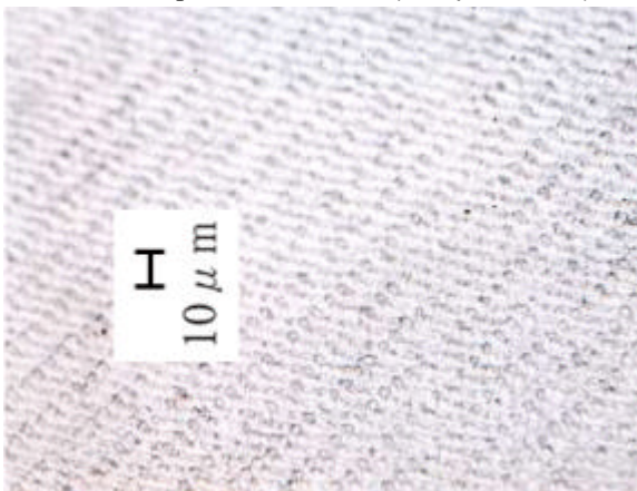
b) s=500\text{rpm}, f=2.5\text{mm}/\text{min} (=5 \mu\text{m}/\text{rev})
